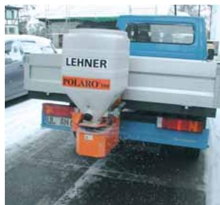
te facilitata proprio grazie alle peculiarità dello spargitore: ridotte dimensioni e azionamento elettrico a 12 V.
